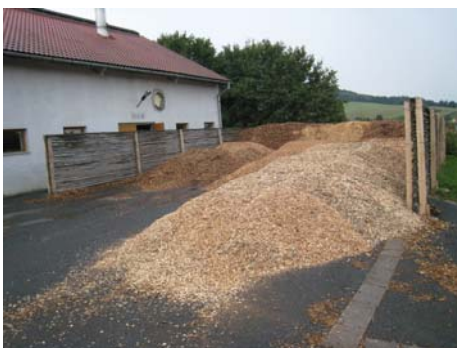
на фото: источник топлива теплостанции - щепы
